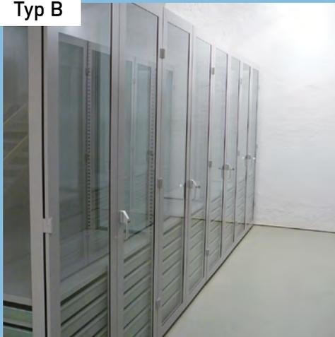
**Reihenschrank aus Einzelkorpus** mit integriertem Schubladenblock und Tablarböden, Sicherheits-schloss mit Profilzylinder, VSG Frontverglasung, Stahlrückwand und variabler Tablarausstattung.
